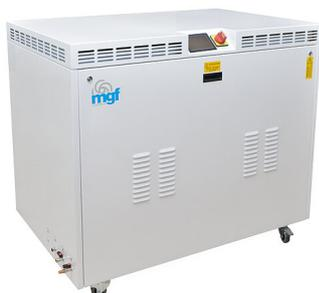
Compressore d'aria a secco versione IOT, 4 cilindri, con una portata d'aria compressa di 340 l/min a 5 bar di pressione. Capacità serbatoio 90 L, trattamento della superficie interna a protezione dalla corrosione.
