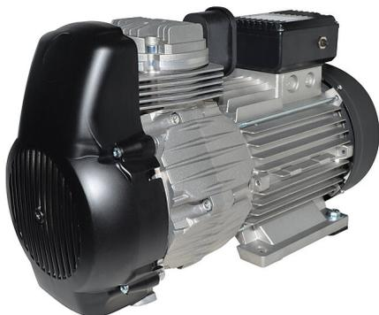
Compressore a secco monocilindrico, 1.320 giri, portata 85 l/min@5 bar, assorbimento massimo 7 A, utilizzabile per impiego intensivo. Massima silenziosità.
