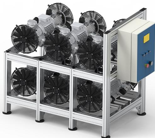
L'unità centralizzata CENTRALAIR 6 è un compressore a secco con capacità di 2.700 l/min a 5 bar e una pressione massima regolabile da 8 a 10 bar. La centralina di controllo è in grado di regolare il funzionamento dei pompanti in maniera tale da garantire pressione costante all'impianto.
