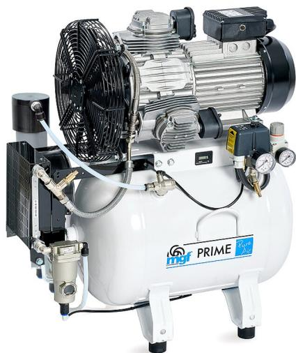
Compressore a secco per un ciclo di lavoro intensivo, 3 cilindri, portata 175 l/min@8 bar, serbatoio da 40 lt., essiccatore a membrana di nuova generazione in grado di fornire aria essiccata fino a -20°C di punto di rugiada.
