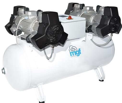
Compressore d'aria a secco trifase versione IOT, 12 cilindri, con una portata d'aria compressa di 900 l/min a 5 bar di pressione. Capacità serbatoio 270 L, trattamento della superficie interna a protezione dalla corrosione.
