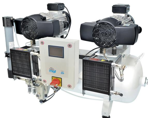
Compressore d'aria a secco versione IOT, 4 cilindri, con una portata d'aria compressa di 305 l/min a 5 bar di pressione. Capacità serbatoio 90 L, trattamento della superficie interna a protezione dalla corrosione.
